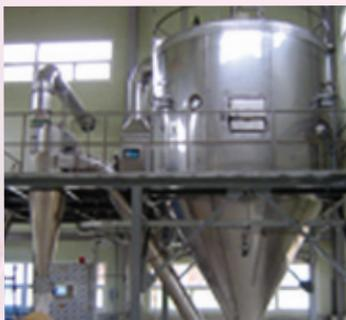
건조실 하단 부위에 SFB(STATIC FLUID BED)가 내장되어 2단 건조가 되며 SFB에서 회수되는 제품이 VIBRATING FLUID BED에서 3차 건조되어 낮은 출고 온도에서도 최종 제품의 수분 함량을 줄일수 있고 열 효율을 증대시킬 수 있습니다.
